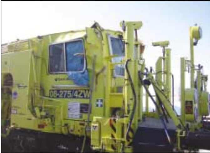
Abb. 3: Universalstopmaschine 08-275/4ZW nach dem Unfall
