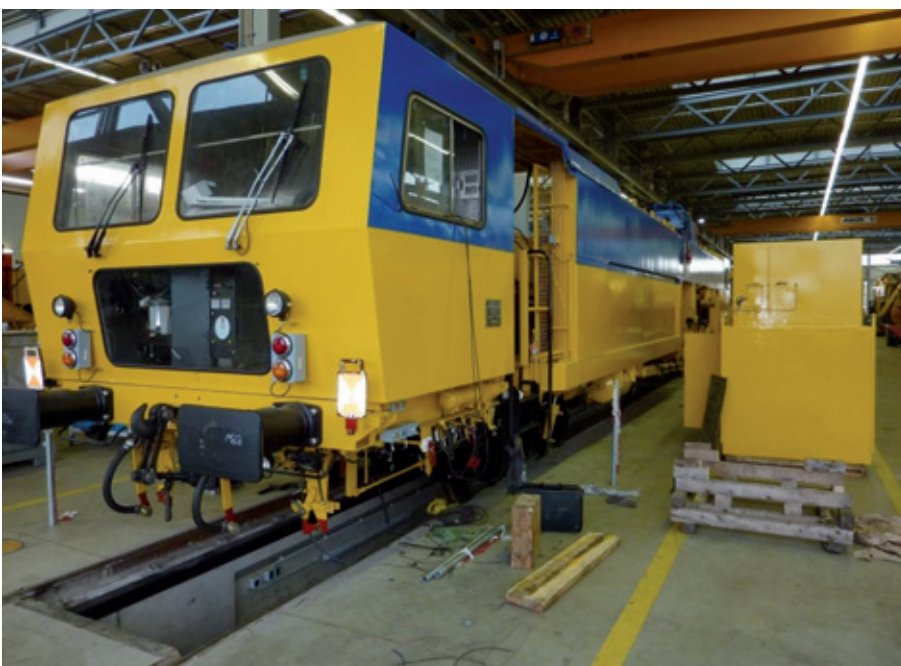
Abb. 7: Komplettüberholung einer Unimat 08-275 3S der Firma bbw-Bahnbau Wels
