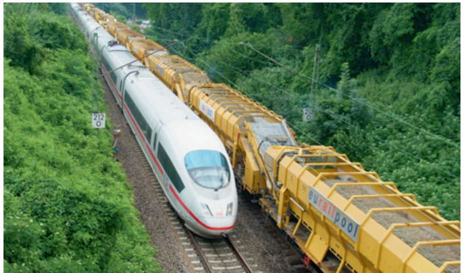
Abb. 3: Effizienzsteigerung durch Einsatz der MFS-Serie. Die Siloeinheiten zum gesteuerten Durchfördern, Speichern und Entladen von Material – in der Erweiterung der Produktionslinie des Baugleises. Das Nachbargleis bleibt stets für den Betrieb frei.
