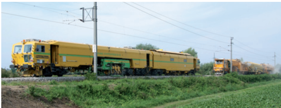
Abb. 2: MDZ 3000 – bestehend aus der kontinuierlich arbeitenden 4-Schwellen-Stopfmaschine Dynamic Stopfexpress 09-4X und dem Schotterbewirtschaftungssystem BDS 2000
